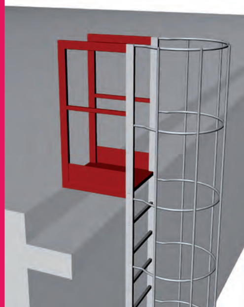
PIATTAFORMA DI SBARCO LANDING PLATFORM
