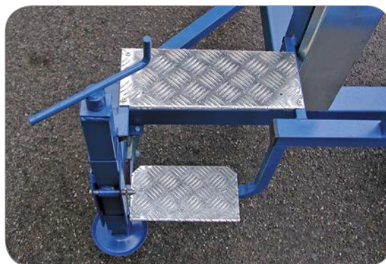
GRADINI DI ACCESSO ALLA PIATTAFORMA
